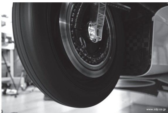
照片 13 轮胎 + 轮毂电机（东海大学）
